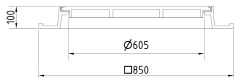
Poklop EUROPA 9 s panem, víko litina bez ventilace s uzavřeným panem tichý design, pružinové zajištění víka v rámu, E600, rám litina patkový čtvercový v.100mm bez osazení pro lapač, horizontální a vertikální PUR tlumící vložka na víku
