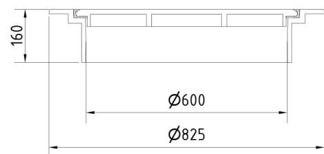
Poklop EUROPA 9 s panem, víko litina bez ventilace s uzavřeným panem tichý design s mušlí, pružinové zajištění víka v rámě, E600, rám litina samonivelační těžký v.160mm s osazením pro lapač, horizontální a vertikální PUR tlumící vložka na víku
