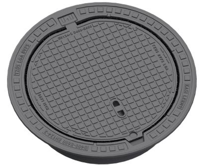
Poklop EUROPA 9 s pantem, víko litina bez ventilace s uzavřeným pantem tichý design s mušlí, pružinové zajištění víka v rámu, E600, rám litina samonivelační těžký v.200mm bez osazení pro lapač, horizontální a vertikální PUR tlumící vložka na víku
