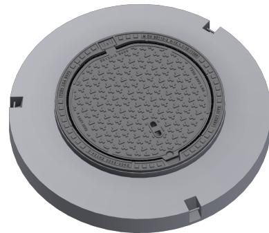
Poklop EUROPA 9 s pantem, víko litina bez ventilace s otevřeným pantem s mušlí, pružinové zajištění víka v rámu, E600, rám beton-litina roznášecí DN1200 v.200mm bez osazení pro lapač, horizontální a vertikální PUR tlumící vložka na víku
