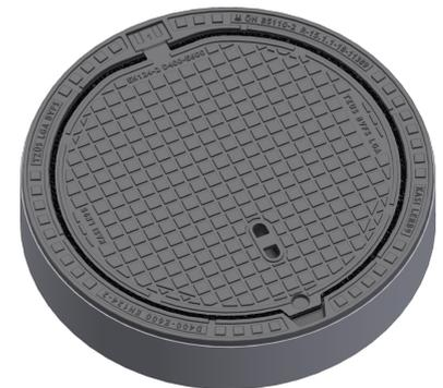
Poklop EUROPA 9 s pantem, víko litina bez ventilace s uzavřeným pantem tichý design s mušlí, pružinové zajištění víka v rámu, E600, rám beton-litina v.160mm s osazením pro lapač, horizontální a vertikální PUR tlumící vložka na víku
