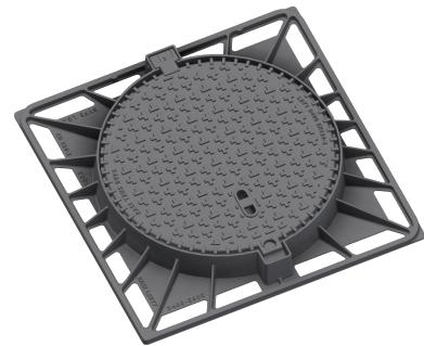
Poklop EUROPA 7 s panem, víko litina bez ventilace s otevřeným panem, pružinové zajištění víka v rámě, D400, rám litina patkový čtvercový v.100mm bez osazení pro lapač, horizontální PUR tlumící vložka na rámě, s mušlí
