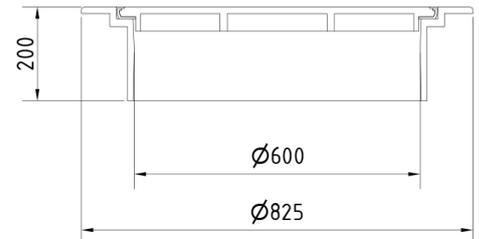
Poklop EUROPA 9 s pantem, víko litina s ventilací s otevřeným pantem, pružinové zajištění víka v rámu, D400, rám litina samonivelační těžký v.200mm bez osazení pro lapač, horizontální a vertikální PUR tlumící vložka na víku
