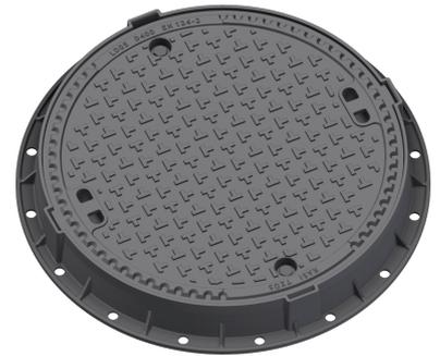
ohne Scharnier, PUR-Dämpfungseinlage, ohne Sicherung des Deckels im Rahmen durch Feder, tagwasserdicht 0,5 bar
