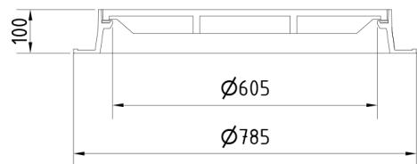
Poklop EUROPA s pantem, víko litina s ventilací s uzavřeným pantem, pružinové zajištění víka v rámu, D400, rám litina patkový v.100mm s osazením pro lapač, horizontální PUR tlumící vložka na rámu
