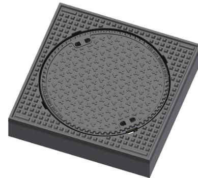
Abdeckung ohne Scharnier, horizontale PUR-Dämpfungseinlage am Rahmen, horizontale und vertikale PUR-Dämpfungseinlage am Deckel, ohne Sicherung des Deckels im Rahmen durch Feder
